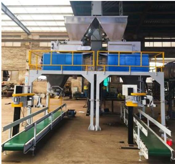
Diseño que combina un sistema de tolvas doble. Pensando en facilitar las maniobras de envasado de productos de fácil fluidez como: granos, semillas, fertilizantes, materias primas granulares, etc. Disponible en acero al carbón, acero inoxidable partes en contacto o acero inoxidable, de tolva de una salida o tolva para dosificador. Cuenta con accesorios disponibles como: juego de laterales adicionales para aumentar volumen y paquete de instalación electro neumática. Parámetros técnicos.:
